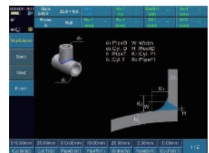
Сварной шов тройников
