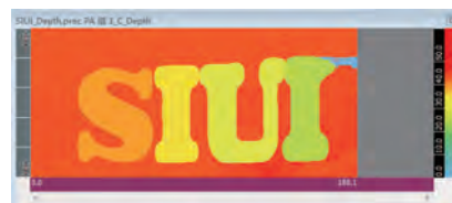
C-развертка, показывает отображение глубины используется для контроля коррозии
