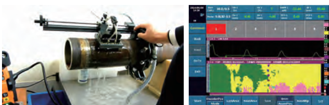
РА сканер для контроля коррозии (XY направление)
