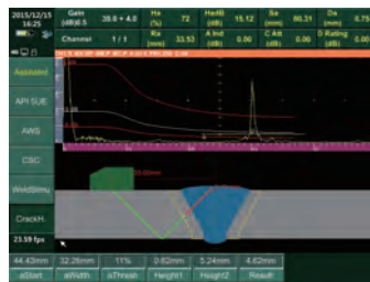
Измерение глубины залегания дефекта
