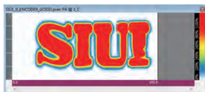
C-развертка, показывает отображение амплитуды
