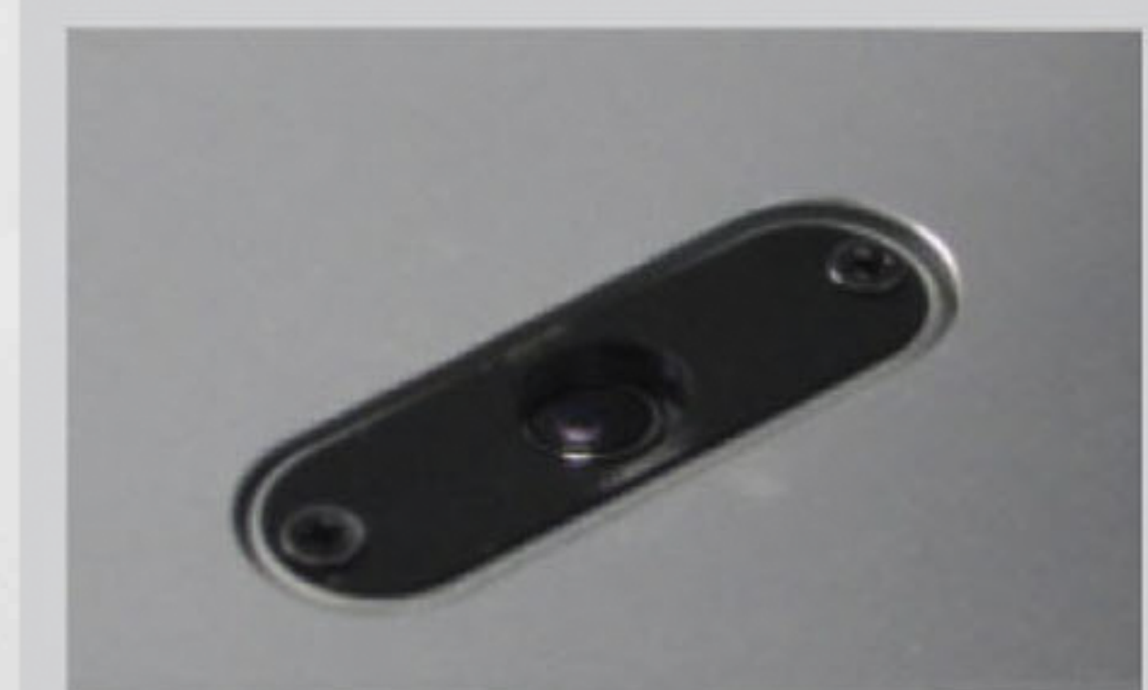
Камера 5 Мп для наблюдения за образцами
