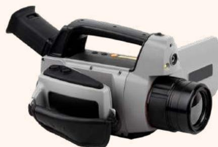
**Тепловизионные камеры ТЕРМО ПРО М** - ручные профессиональные тепловизоры с разрешением 640 × 480 пикселей, частотой кадров 50 Гц или 60 Гц. Тепловизоры построены на базе неохлаждаемого микроболометра в фокальной плоскости (FPA), измеряют и анализируют распределение температуры объектов в диапазоне от -40 до 650 °С (опционально до 1200) °С. Погрешность всего ± 2 °С или ± 2%.
