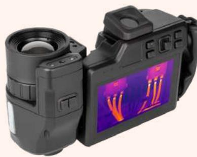
Тепловизионные камеры ТЕРМО ПРО А и А+ с матрицей 640×480/1024×768 и сменной частотой кадров 60 Гц предназначены для тепловизионного обследования технических объектов в ИК-диапазоне (7,5...14 мкм), различают нагретые зоны с разницей температур в 0,04 °С.
